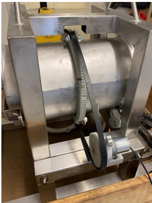
Figur 3: Specialkonstruerad reaktor använd vid lakning i kg-skala.
